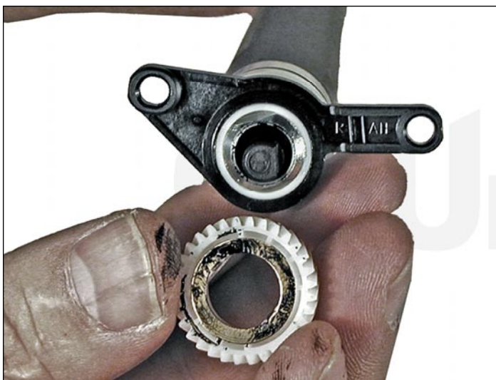
20. Remueva el engranaje guía del rodillo magnético y la placa de contacto de cobre, para que no se pierdan.
