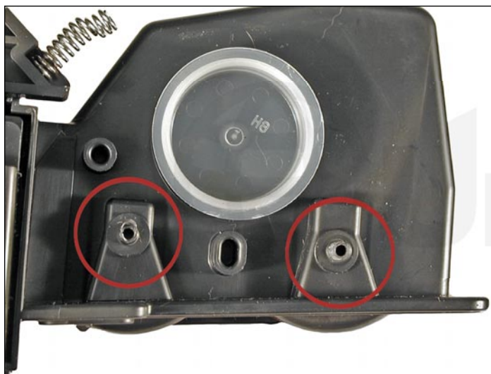
31. Mientras sostiene la cubierta lateral restante en su sitio, taladre dos agujeros pequeños en el lugar donde estaban los pernos de plástico. Instale dos tornillos para mantener la cubierta lateral en su sitio.
