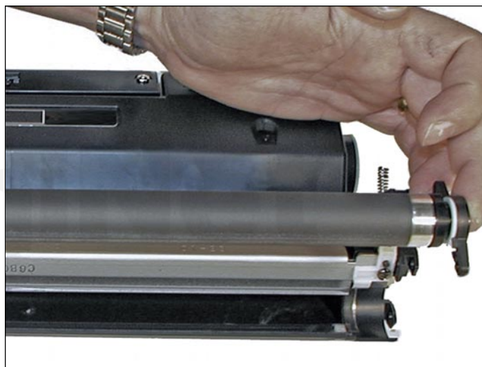
19. Remueva el ensamble del rodillo magnético del cartucho.
