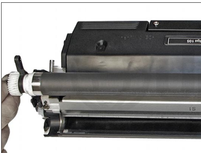
19. Remueva el ensamble del rodillo magnético del cartucho.
