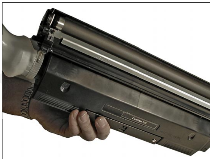
30. Llene la cavidad de tóner con 500 gramos de tóner especial para el cartucho Canon EP105. Coloque el tapón de llenado.
