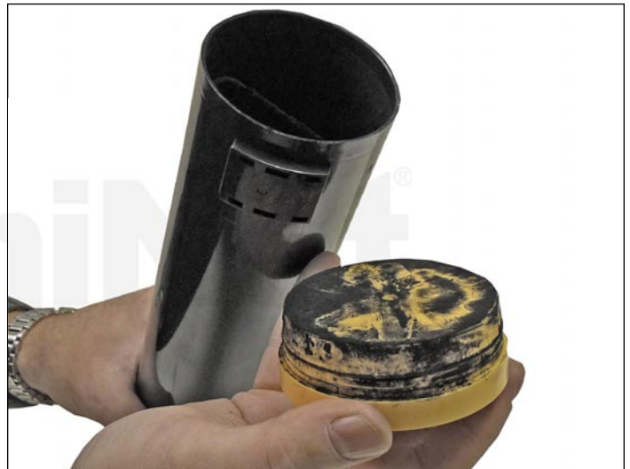
2. Remueva la cubierta lateral.
