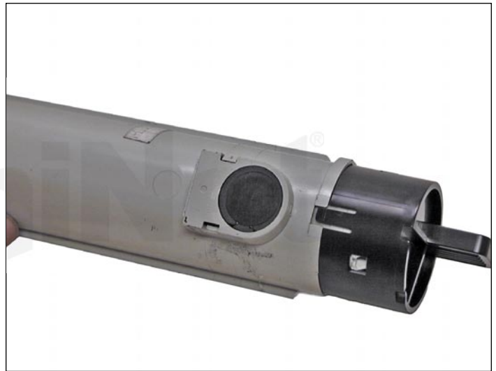
8. Coloque el chip en la base del cartucho.
