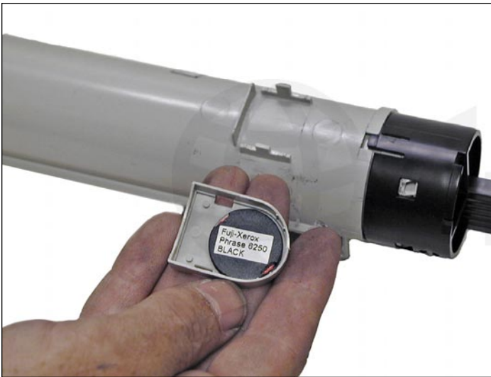
7. Separe el chip de la base, reemplace el chip.
