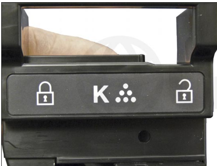
1. Quite la etiqueta del final de la cubierta lateral.
