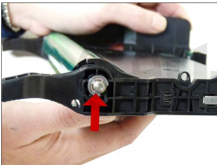
9. En la cavidad de desperdicio, remueva la rondana tipo E del lado del engranaje no guía del eje del cilindro.
