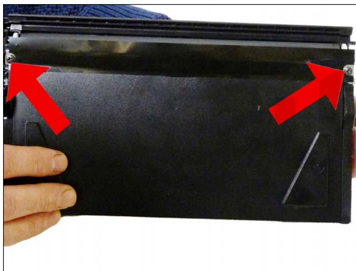
25. Remueva los dos tornillos en la cuchilla dosificadora.
