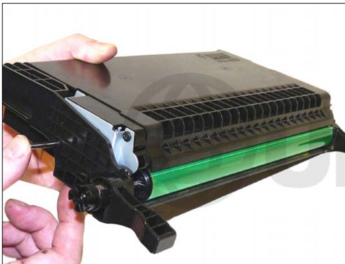
39. Instale los dos pines de fijación. El pin mas largo colóquelo hacia el lado del engranaje guía. Instale los dos resortes a través de las dos mitades.
